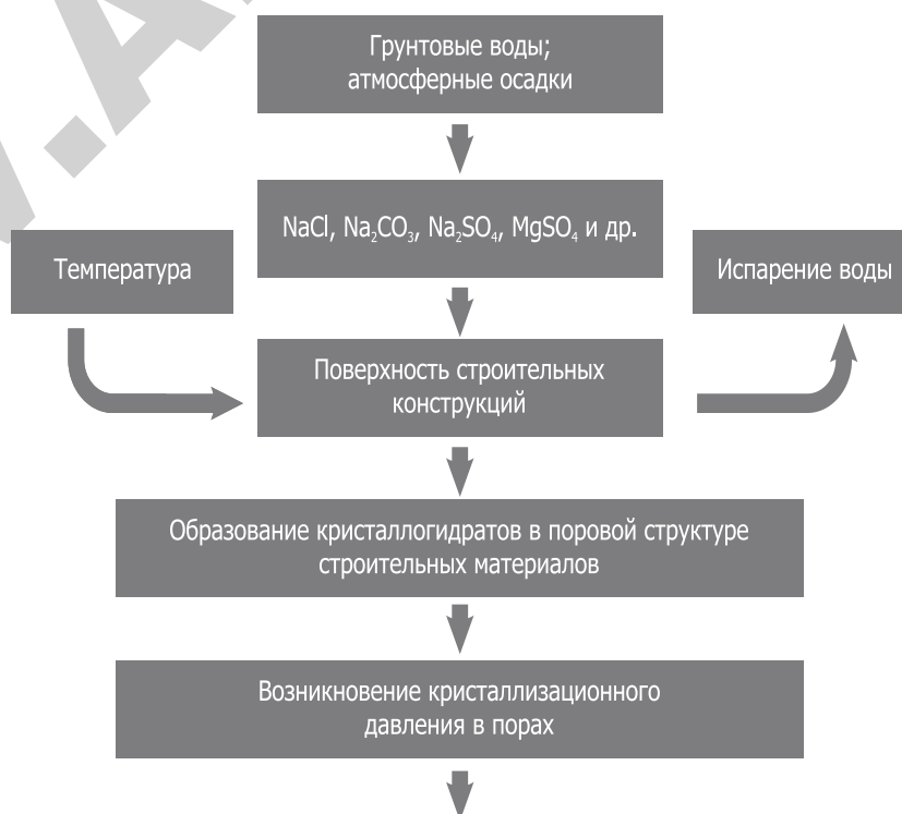
Рис.1. Принципиальная схема образования высолов.
