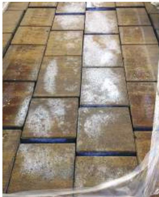
Рис. 4. Усугубление процесса высолообразования внутри паллет с продукцией.
