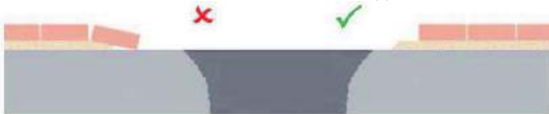
Рисунок 9.1 — Неправильный и правильный варианты ремонта покрытия
