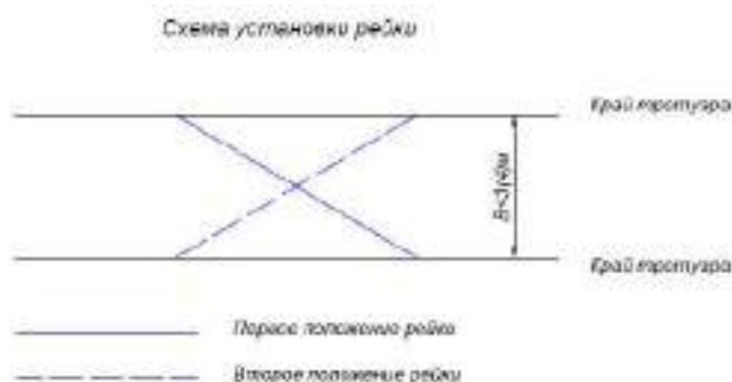
Рисунок 2– Измерение ровности в поперечном направлении (В- ширина тротуара, меньше длины рейки)
