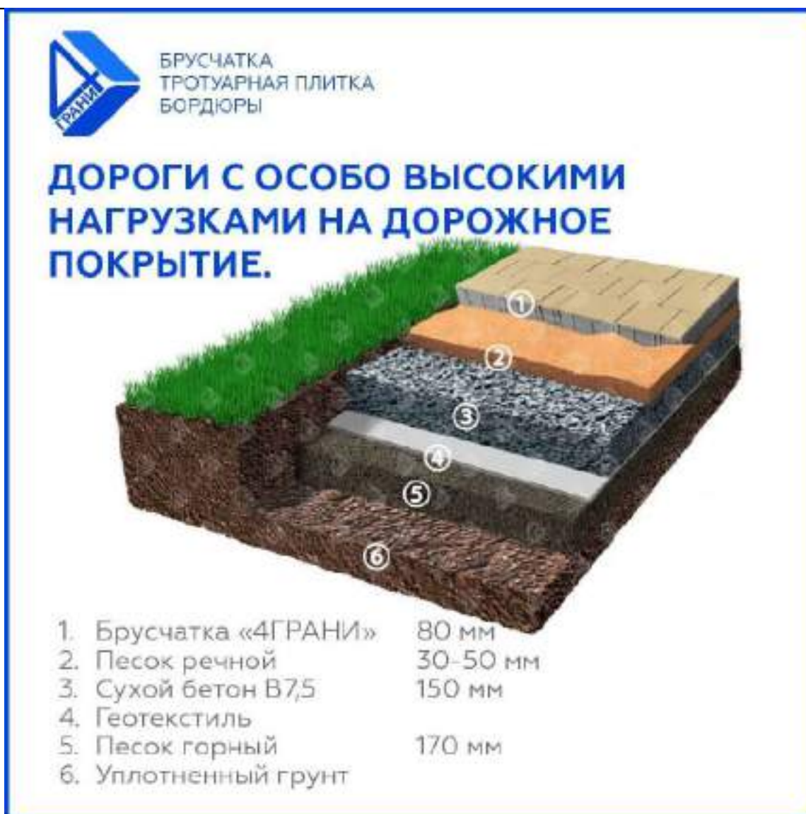
Рисунок 1 – Типовая конструкция проезжей части
