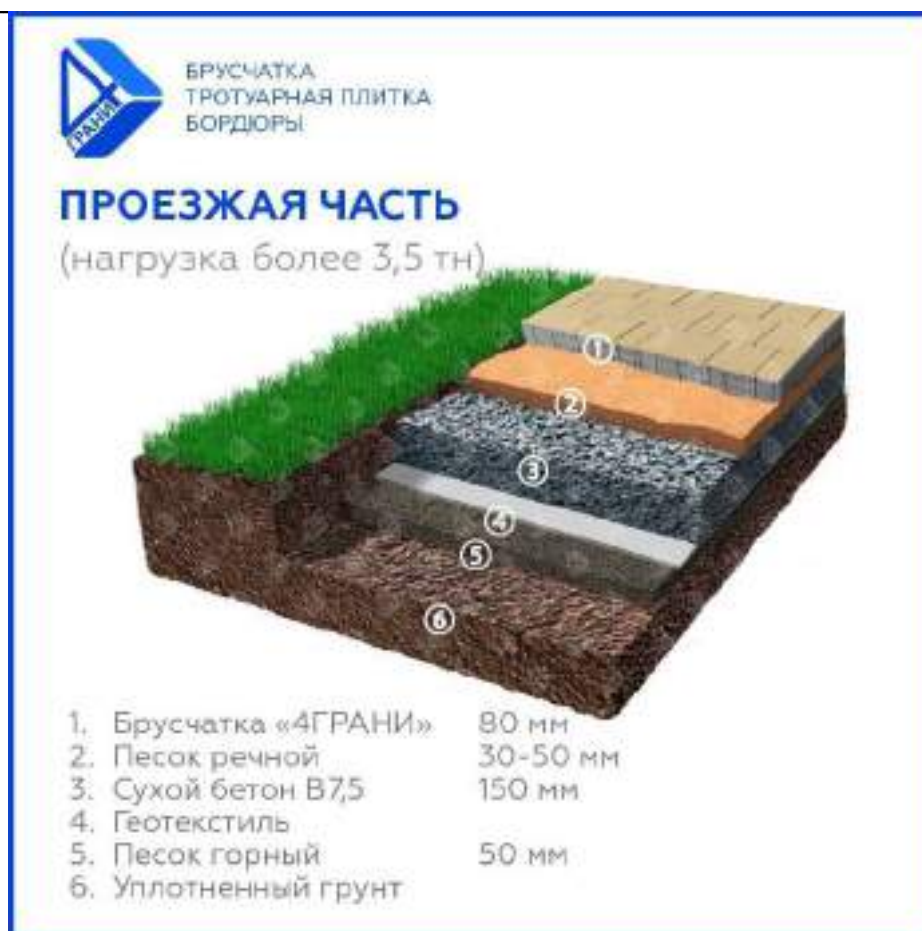
Рисунок 1 – Типовая конструкция проезжей части
